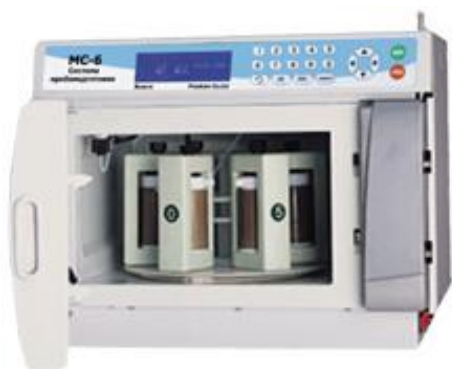
Рисунок 5.9 - Микроволновая печь MC-6 для пробоподготовки экологических проб (фирма «Вольта», Санкт-Петербург)
